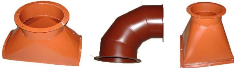
Воздуховоды металлические сварные круглого и прямоугольного сечения изготавливаются из тонколистовой стали толщиной более 1 мм.
